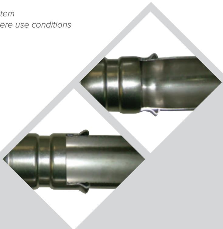
El elemento básico del sistema **NUMEPRESS-SCH** es la unión prensada de accesorio con junta tórica y tubo. La junta se coloca en los extremos del accesorio y es la que produce la estanqueidad de la unión. Una vez introducido el tubo en el accesorio hasta el tope, la unión se produce por la deformación mecánica que realiza una herramienta electro-hidráulica.
